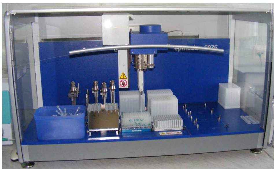
Obr. 3. Automatický pipetovací robot, napr. na izoláciu 96 vzoriek DNA.
