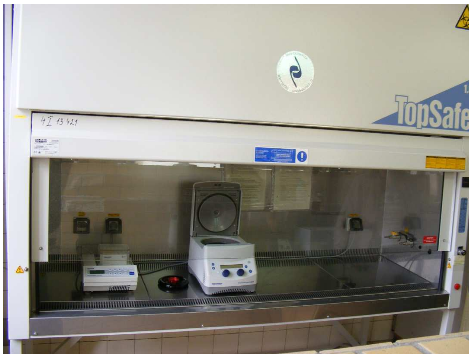
Obr. 2. Laminárny box na izoláciu nukleových kyselín, prácu s DNA, RNA atď.
